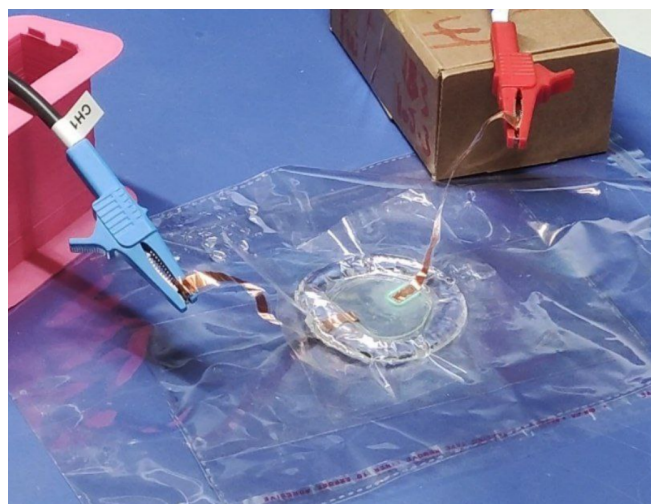
Рис. 4: Пример подключения высоковольтных кабелей Gen-A201 к нагрузке.
