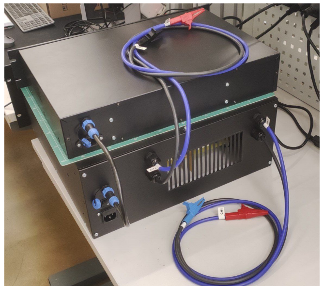
Рис. 3: Задняя панель Gen-A201: разъёмы питания, межблочные соединения и выходные кабели.
