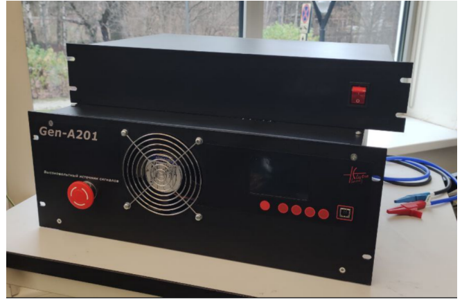
Рис. 2: Передняя панель Gen-A201: экран, кнопки управления и кнопка аварийной остановки.
